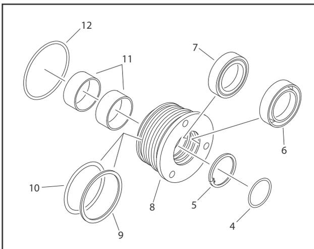
**Figure 5-7. Cylinder Head Disassembly**
